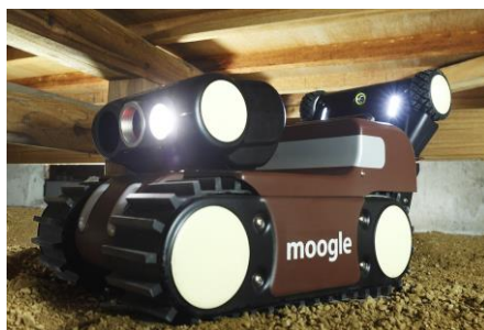
【床下点検ロボット「moog!e」】
