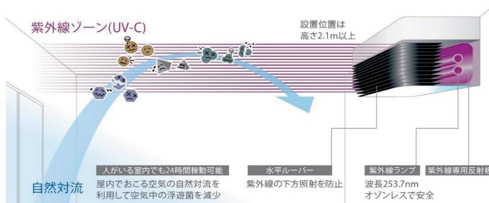
「エアロシールド」は紫外線の中でも最も効果が高い波長とされている UV-C を室内上部に照射し、自然対流による空気の循環を利用して空気環境対策をすることが可能な製品です。
